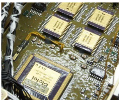
Rysunek 11 Widok, opartego o układ FPGA „anti-fuse” modułu sterującego blokami DCDC zasilacza MXGS FM
