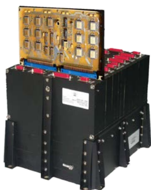
Rysunek 7 Model lotny HLCU. Pokazana jedna z płytek elektronicznych
